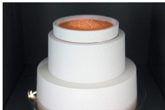
Abb. 3: Korrekte Anwendung und Aussehen des Pulvers vor dem Reinigungsbrand.
