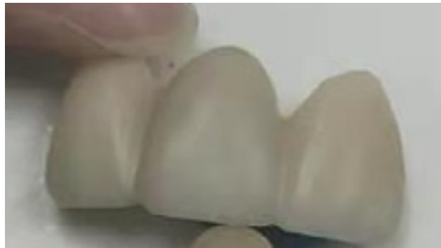
Abb. 13: Bei einer Brücke aus DD cube ONE® ML C2 wurde die Sintertemperatur deutlich überschritten, die Farbe ging verloren und die Inzisalkante erscheint opaker.
