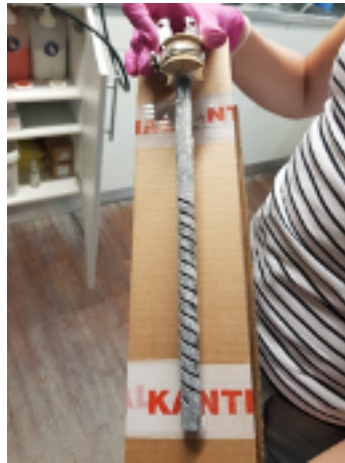
Abb. 2: Abgenutzte SiC Heizelemente, Abnutzung zeigt sich als weißer Belag
