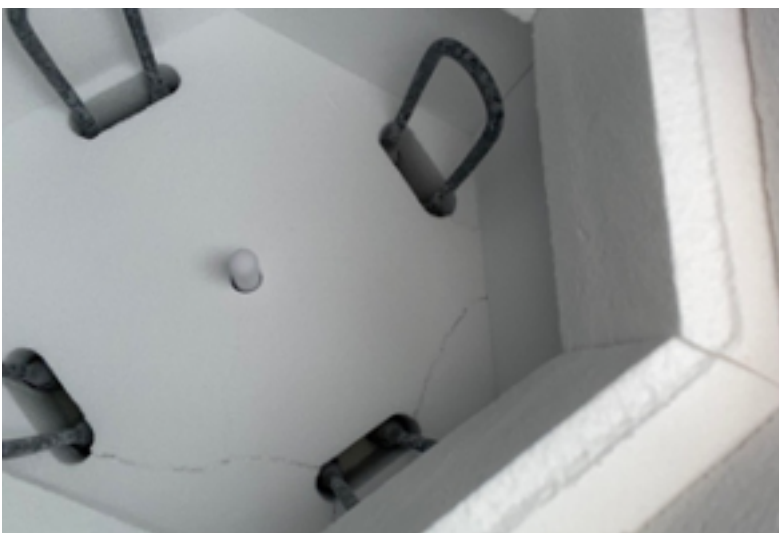
Abb. 1: Abgenutzte MoSi 2 Heizelemente; Abnutzung zeigt sich als weißer Belag
