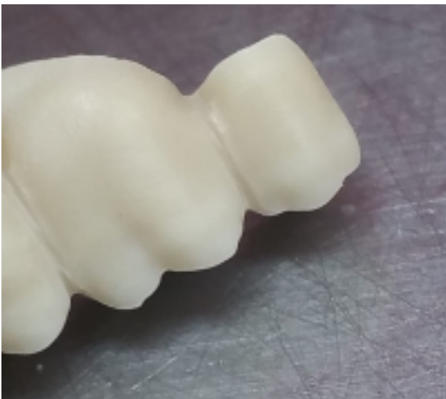
Abb. 15: deutlich untergebrannte Konstruktion aus DD cube ONE ® ML C3: Lackschichten deutlich sichtbar
